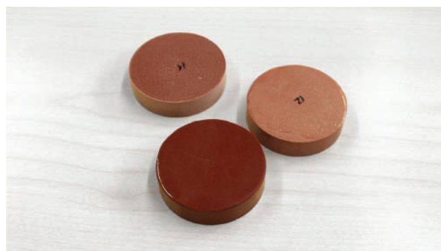
Изменение цвета образца отливок из смолы в результате воздействия продуктов декомпозиции элегаза SF 6
