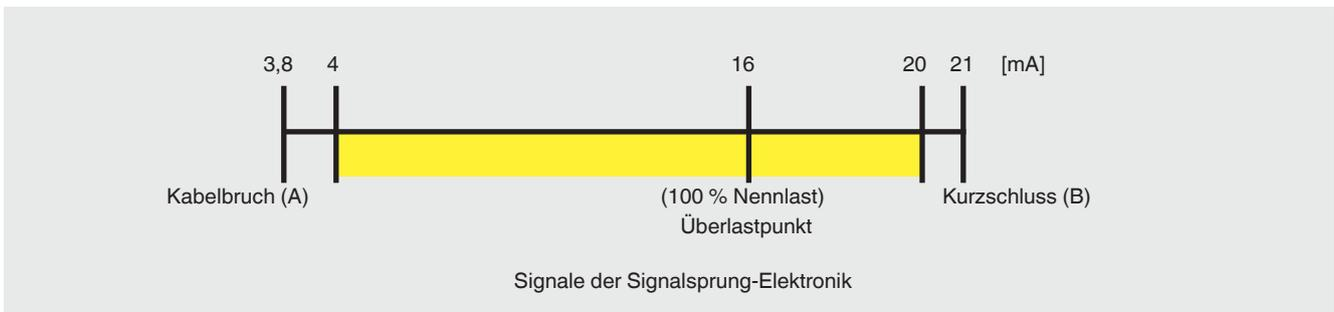
Mit einem fest eingestellten Signalsprung von beispielsweise 4 mA kann dann in jedem Betriebszustand bei Aktivierung des Prüfrelais der Testzyklus ausgelöst werden.
