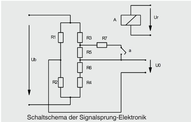
Bei diesen Kraftaufnehmern werden vier veränderliche Widerstände (R1 ... R4) zu einer Wheatstone'sche-Messbrücke zusammengeschaltet. Bei Verformung des Messkörpers werden die jeweils gegenüberliegenden Widerstände in gleicher Weise gedehnt bzw. gestaucht. Dies führt zu einer Verstimmung der Brücke und einer Diagonalspannung  $U_0$ .
