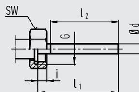
Comprimento de inserção padrão  $l_1 = 89, 126, 186, 226, 276$  mm
