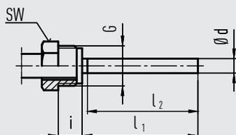
Comprimento de inserção padrão  $l_1 = 80, 140, 180, 230$  mm
