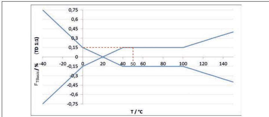
Fig. 43: Détermination de l'erreur de température de base pour l'exemple ci-dessus :  $F_{TBase} = 0,15\%$
