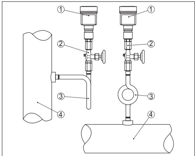
Fig. 16: Disposition de mesure pour la mesure de pression process de vapeurs dans des conduites
