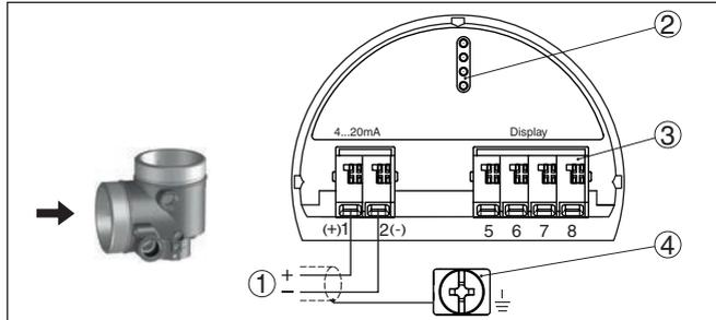
Fig. 23: Compartiment de raccordement - boîtier à deux chambres
