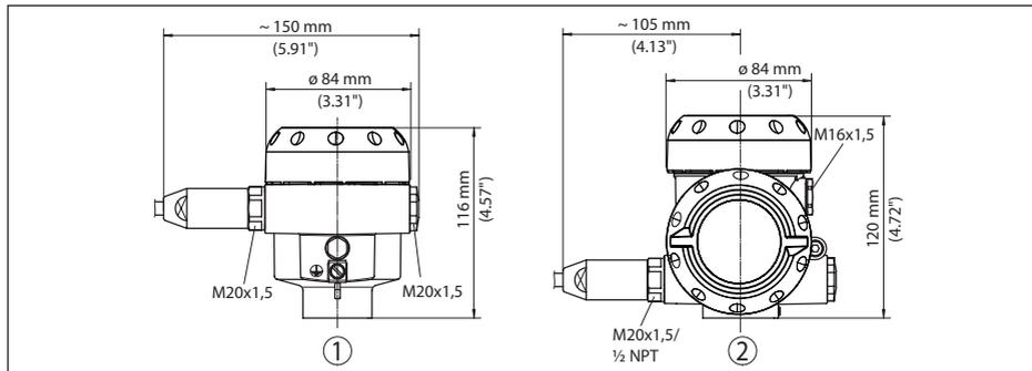
Fig. 46: Variantes de boîtier en protection IP66/IP68 (1 bar), (avec un module de réglage et d'affichage intégré, la hauteur du boîtier augmente de 9 mm/0.35 in)
