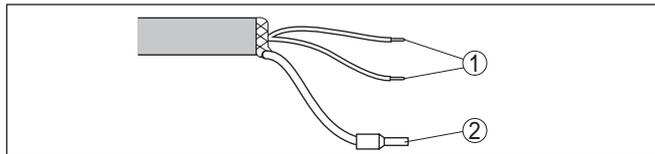
Fig. 24: Affectation des conducteurs du câble de raccordement raccordé de façon fixe
