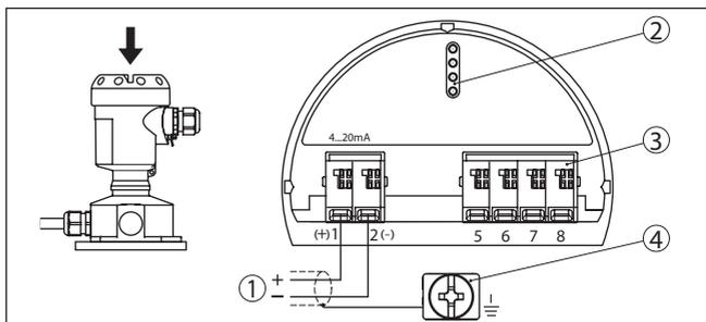
Fig. 28: Compartiment électronique et de raccordement boîtier externe
