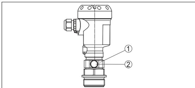
Fig. 12: Position de l'élément filtre - version Ex-d
