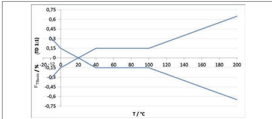
Fig. 39: Erreur de température de base  $F_{T-Basis}$  avec TD 1 : 1
