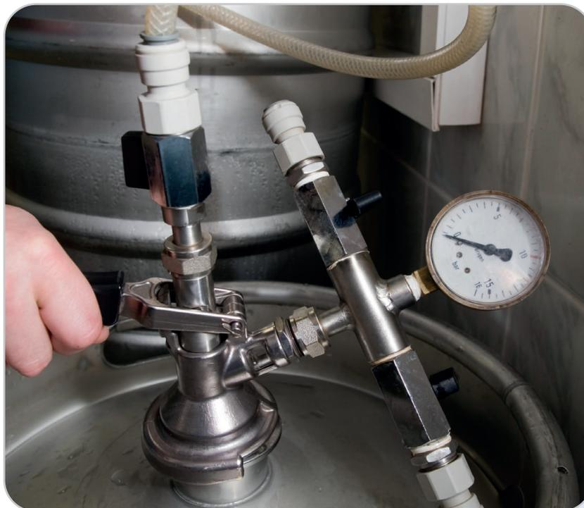
Конструкция систем розлива пива подчиняется строгим техническим характеристикам и требованиям к производительности. Манометры используются с регуляторами для управления потоком газа для подачи пива, то есть смеси  $\text{CO}_2$  и  $\text{N}_2$ .
