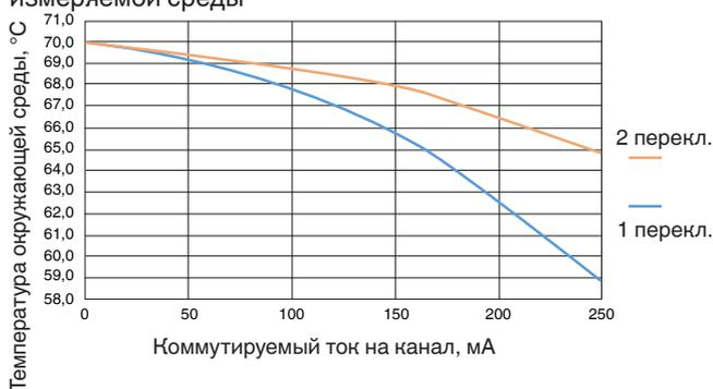
Макс. температура окружающей среды, если температура измеряемой среды = 85 °C [185 °F]
