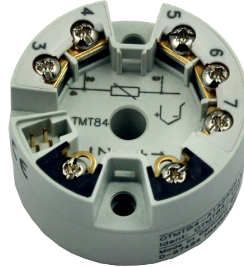
Transmissor de temperatura Fieldbus, modelo OTMT84
