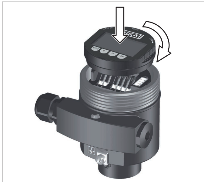
Figura 12: Installare il tastierino di taratura con display
